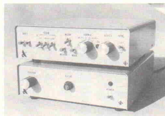
Video-Speicher von UKW-Technik. Er setzt Funksignale in Bilder um, die man direkt per Fernsehgerät anschauen und speichern kann.
